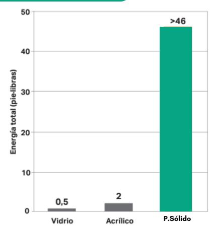
\*Impacto instrumentado según ASTM D 3763, grosor de muestra 0,125" nominal
