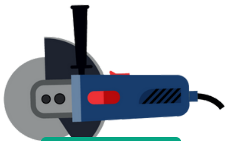
Esmeril de mano de baja revolución, disco no dentado.
