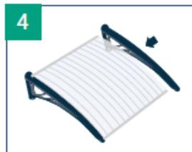
4 Fije el otro extremo de la plancha en el segundo soporte, use los tarugos y tornillos correspondientes.
