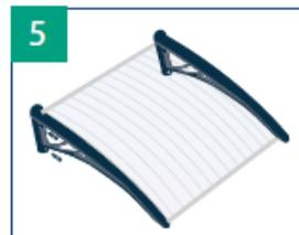
5 Finalmente fije el segundo soporte al muro, utilizando los pernos de anclaje incluidos en el Kit.
