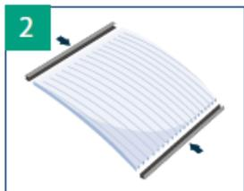
2 Instale a presión los perfiles de inicio y término en la plancha de policarbonato alveolar.
