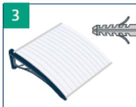
3 Fije la plancha al soporte ya instalado, utilizando los tarugos y tornillos correspondientes.
