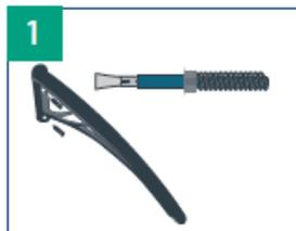
1 Fije uno de los soportes al muro en la ubicación deseada, utilizando los pernos de anclaje.
